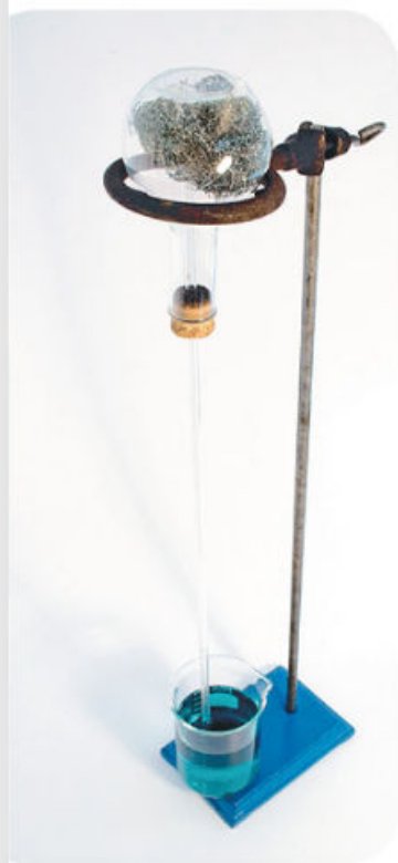
Fig. 3.3. Asegúrense de que el tapón quede bien colocado para que el sistema no tenga fugas. Si no cuentan con matraz, pueden cambiarlo por una botella de plástico rígido.
