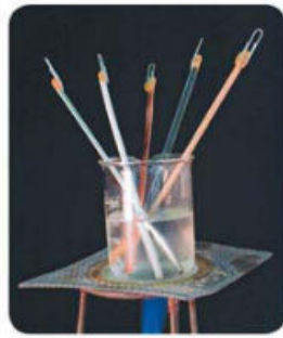
Fig. 2.31. Cuiden que los clips queden a la misma altura en todos los objetos, para que puedan comparar cuáles transmiten mejor el calor.
