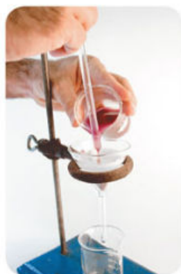
Fig. 3.6. No muevan el papel filtro mientras está en el embudo, para que no se rompa y pierdan parte del sólido.
