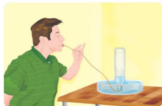
Fig. 1.24. Para que el gas desplace al líquido, debe ser insoluble en él.
