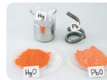
Fig. 1.71. Hoy sabemos que los polvos generados al calentar metales son sus óxidos, y tienen más masa que el metal porque se combinan químicamente con el oxígeno del aire.
