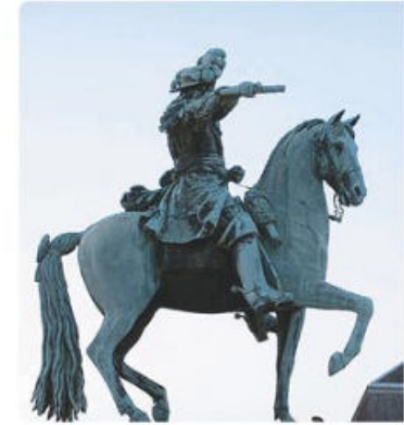
Fig. 2.33. El bronce tiene color amarillento, diferente al rosado del cobre o el plateado del estaño que forman esa aleación. Pero con el paso del tiempo, se cubre de óxido verdoso.
