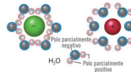
Fig. 4.9. Los iones en disolución acuosa son rodeados por moléculas de agua gracias a su polaridad o reparto desigual de carga.
