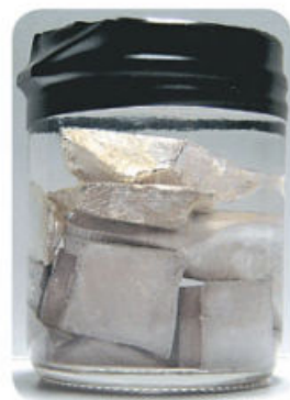
Fig. 2.54. Los metales alcalinos en su forma metálica, como el sodio, deben conservarse en solventes derivados del petróleo que los aíslan del aire.
