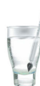
Fig. 1.34. Cuanto mayor es la densidad menos se hunde el densímetro, precisamente por el principio de Arquímedes.
