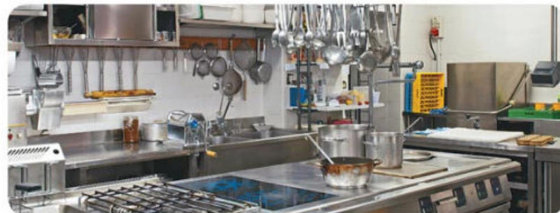
Fig. 2.35. Las cubiertas de las cocinas suelen ser de acero inoxidable, más tenaz, rígido y duro que el aluminio.
