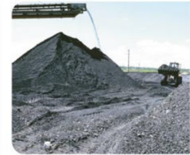
Fig. 3.12. El primer paso para procesar minerales y transformarlos en metales consiste en triturarlos lo más posible, pues el cambio químico es más efectivo que si se tratan las piedras grandes.
