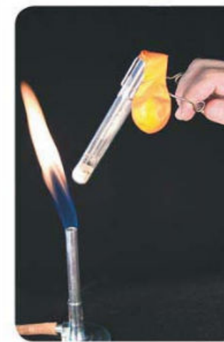
Fig. 1.74. Nunca calienten un tubo dirigiendo la boca de este hacia alguna persona.
