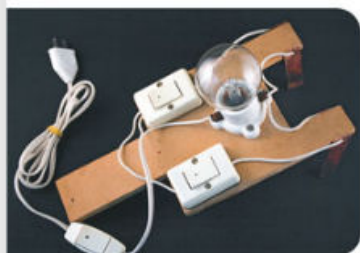
Fig. 4.11. El aparato resulta mejor si la tabla tiene el grosor suficiente para que puedan fijar las láminas con tornillos.
