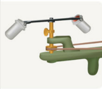
Fig. 1.57. Las centrifugas antiguas eran manuales, con sistemas de engranes. Las modernas son eléctricas y pueden procesar varios tubos a la vez.
