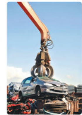
Fig. 2.40. Para recuperar el hierro de coches y basureros se emplean grúas con electroimanes para aprovechar sus propiedades magnéticas.
