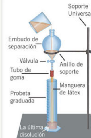
Fig. 1.66. Si no cuentan con un embudo que tenga llave, pueden usar una botella de plástico con un tapón, una manguerita y una pinza de tender la ropa.
