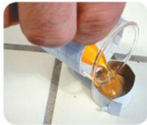
Fig. 2.58. En lugar de vaso desechable pueden hacer un molde de cartón para rodear la moneda. Esperen que se enfríe antes de desarmarlo.
