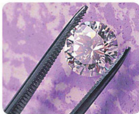
Fig. 1.12. El diamante es el material natural de mayor dureza, ya que con él se puede rayar cualquier material sólido, mientras que sólo otro diamante puede servir para rayarlo, cortarlo o pulirlo.
