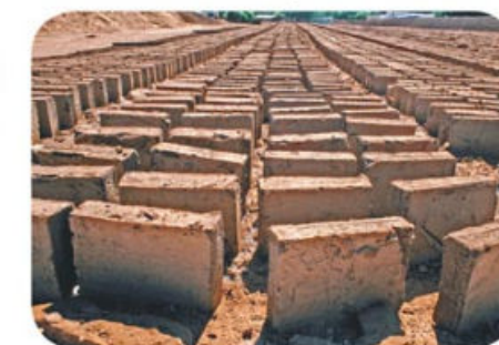
Fig. 5.23. No todos los tipos de tierra sirven para fabricar tabiques; hace falta que haya una proporción adecuada entre arenas, arcillas y limo. Averigüen qué diferencias hay entre estos componentes.
