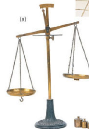
Fig. 1.22. a) La balanza de dos platos se emplea desde la época de los antiguos egipcios. Si las pesas están bien calibradas, la medida será muy exacta. b) La mínima medida que puede hacerse en la balanza granataria es de 0.1 g, es decir, su precisión, por lo que decimos que tiene una incertidumbre de \pm 0.05 g.
