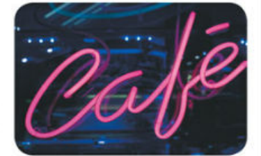
Fig. 2.60. Los focos llenos de gases nobles se conocen como "luces de neón" y son de diferente color.
