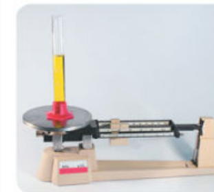
Fig. 1.33. Combinen los instrumentos de medición como convenga para determinar la masa y el volumen.
