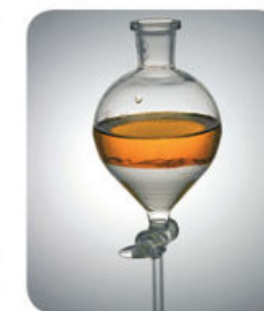
Fig. 1.52. En el embudo de separación o de decantación basta con abrir la llave para que la fase más densa salga del recipiente.
