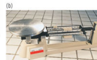
Fig. 1.22. a) La balanza de dos platos se emplea desde la época de los antiguos egipcios. Si las pesas están bien calibradas, la medida será muy exacta. b) La mínima medida que puede hacerse en la balanza granataria es de 0.1 g, es decir, su precisión, por lo que decimos que tiene una incertidumbre de \pm 0.05 g.
