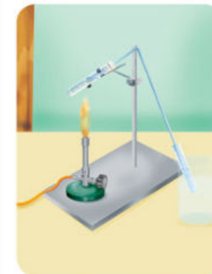
Fig. 2.72. Calienten con cuidado y antes de terminar el calentamiento retiren la manguera de la disolución, para que esta no se absorba hacia el tubo caliente al enfriarse.
