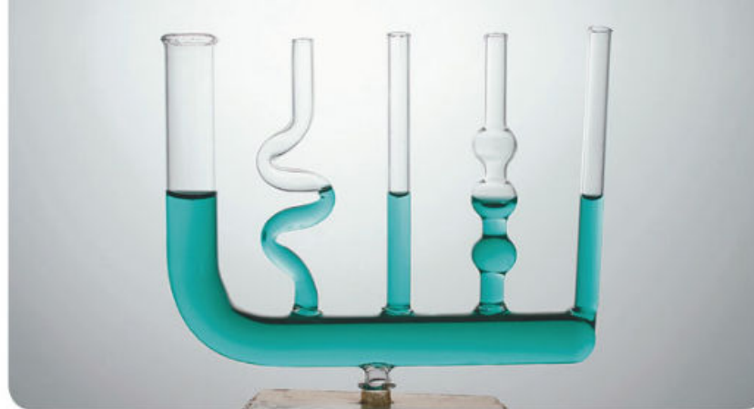
Fig. 1.13. Una de las características de un líquido es que cuando llena un recipiente con varias cavidades, como estos vasos comunicantes, alcanza el mismo nivel en todas ellas, sin importar su forma o su grosor.
