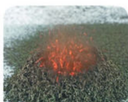
Fig. 4.42. Una vez encendido, el dicromato de amonio ( (\text{NH}_4)_2\text{Cr}_2\text{O}_7 ) continúa la reacción de forma espontánea, ya que es exotérmica.
