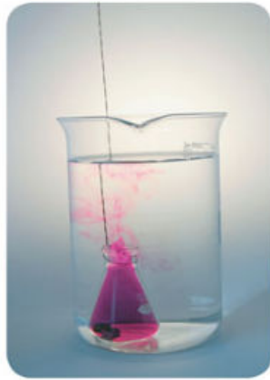
Fig. 1.42. El uso de materiales coloridos nos permite apreciar cómo se van integrando al hacer la disolución.
