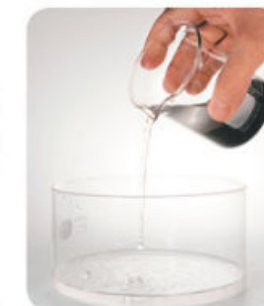
Fig. 1.51. La decantación más sencilla se logra al tirar el líquido o sobrenadante y dejar el sólido o sedimento.
